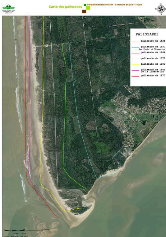
Figure 15. Au sud de l'île d'Oléron, emplacement (lignes de couleur) et disparition progressive des palissades
